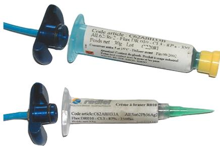
L'embout pneumatique se fixe par quart de tour. Ici, un contact à effleurement permet le déclenchement d'un dépôt.
