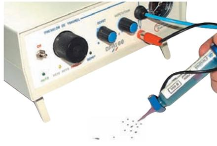
Quelques essais préliminaires pour déposer à chaque point juste la quantité nécessaire, ici pression environ 1bar aiguille  $\phi$  0,5mm. **2**
