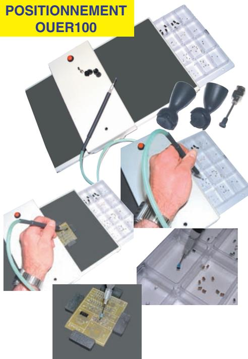
*Sur ce modèle plus élaboré, un bras manipulateur permet la préhension et la rotation du composant à placer.*
